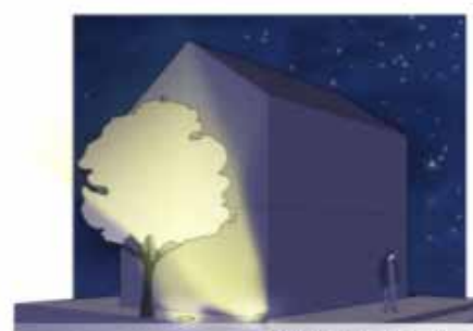
Éclairage très mauvais : le flux est dirigé du bas vers le haut et éclaire la végétation. Il y a une forte nuisance sur la végétation et la faune hébergée ainsi qu'une forte pollution lumineuse.
