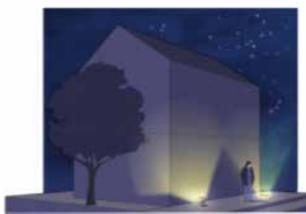
Éclairage mauvais : le flux est dirigé du bas vers le haut avec de fortes déperditions et une forte pollution lumineuse.
