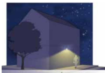
Éclairage bon : le flux lumineux est dirigé vers le bas aucun flux n'est émis au-dessus du plan horizontal. La pollution lumineuse est limitée.
