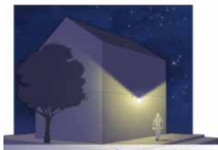
Éclairage moyen : le flux est majoritairement dirigé vers le bas mais une partie importante de celui-ci dépasse le plan horizontal. La pollution lumineuse est importante.
