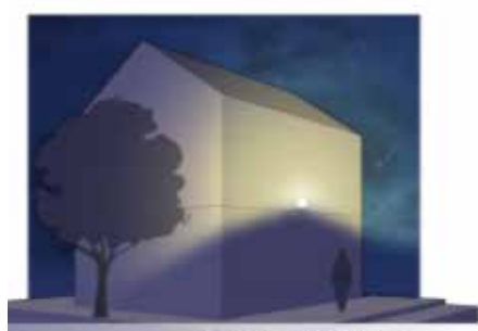
Éclairage très mauvais : une grande partie du flux lumineux est perdue dans le ciel avec pour conséquences un gaspillage d'énergie et une pollution lumineuse très importante.
