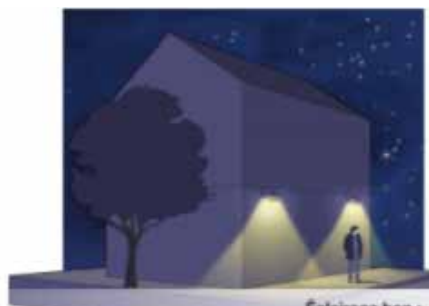
Éclairage bon : le flux est dirigé du haut vers le bas, la végétation n'est pas éclairée et la pollution lumineuse est limitée.
